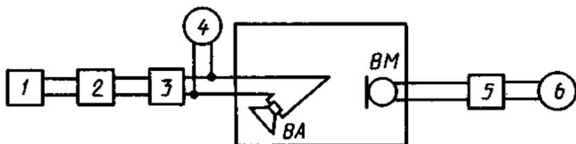
1 – генератор ГШН; 2 – полосовой третьоктавный или октавный фильтр; 3 – усилитель мощности У1; 4, 6 – электронные вольтметры; 5 – микрофонный усилитель УМ; ВМ – измерительный микрофон; ВА – контролируемый громкоговоритель
