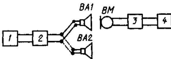
1 – импульсный генератор; 2 – усилитель мощности У1 или У2;
