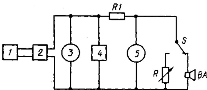
1 – генератор ГНИ; 2 – усилитель мощности У1; 3, 5 – электронные вольтметры;
