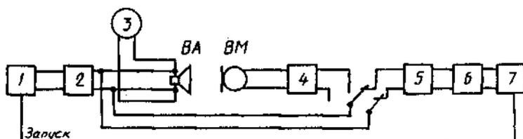
1 – генератор импульсов; 2 – усилитель мощности У1;
