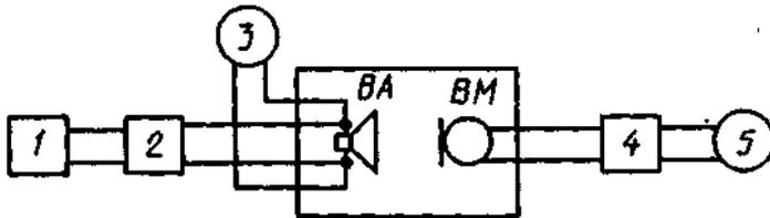
1 – генератор ГНИ; 2 – усилитель мощности У1; 3 – электронный вольтметр; 4 – микрофонный усилитель УМ; 5 – анализатор спектра; ВМ – микрофон для измерения призвука и дребезжания; ВА – контролируемый громкоговоритель
