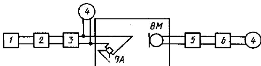
1 — генератор ГШН (розовый шум); 2 — полосовой третьоктавный фильтр; 3 — усилитель мощности У1; 4 — электронный вольтметр; 5 — микрофонный усилитель УМ; 6 — полосовой третьоктавный фильтр со средней номинальной частотой полосы пропускания, кратной средней номинальной частоте полосы пропускания фильтра 2; ВМ — измерительный микрофон; ВА — контролируемый громкоговоритель
