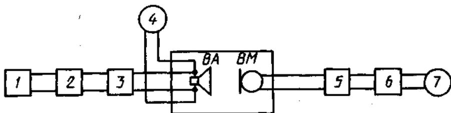
1 – генератор ГШН (розовый шум); 2 – полосовой третьоктавный фильтр; 3 – усилитель мощности У1; 4, 7 – электронные вольтметры; 5 – микрофонный усилитель; 6 – полосовой третьоктавный фильтр со средней частотой полосы пропускания, кратной средней номинальной частоте полосы пропускания фильтра 2; BM – измерительный микрофон; BA – контролируемый громкоговоритель
