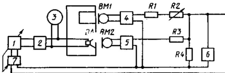
1 – генератор ГНИ; 2 – усилитель мощности У1; 3 – электронный вольтметр; 4, 5 – микрофонные усилители; 6 – универсальный осциллограф; 7 – регистрирующее устройство; *BA* – контролируемый громкоговоритель; *BM1*, *BM2* – измерительные микрофоны; *R1* – резистор сопротивлением  $5,6 \text{ кОм} \pm 20\%$ ; *R2* – переменный резистор сопротивлением  $22 \text{ кОм}$ ; *R3* – резистор сопротивлением  $8,2 \pm 20\%$ ; *R4* – резистор сопротивлением  $0,47 \text{ кОм}$
