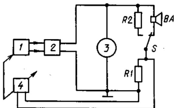
1 – генератор ГНИ; 2 – усилитель мощности У1; 3 – электронный вольтметр;
