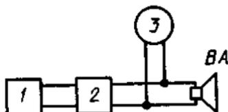
1 – генератор ГНИ; 2 – усилитель мощности У1; 3 – электронный вольтметр;
