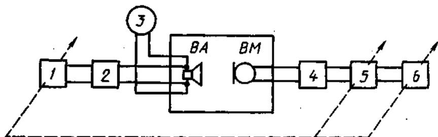
1 — генератор ГНИ; 2 — усилитель мощности У1; 3 — электронный вольтметр; 4 — микрофонный усилитель УМ; 5 — следящий анализатор спектра; 6 — регистрирующее устройство; ВА — контролируемый громкоговоритель; ВМ — измерительный микрофон
