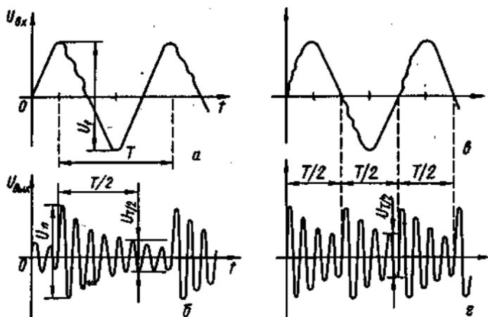
$U_{вх}$  (а, в) – сигнал на входе фильтра ФВЧ;  $U_{вых}$  (б, г) – сигнал искажений (призвук) на выходе фильтра ФВЧ;  $T$  – период возбуждающего сигнала;  $U_n$  – двойное амплитудное значение (размах) сигнала призвука на выходе ФВЧ;  $U_{T/2}$  – размах сигнала призвука через  $T/2$  после его начала;  $U_f$  – размах сигнала на входе ФВЧ на частоте возбуждения громкоговорителя
